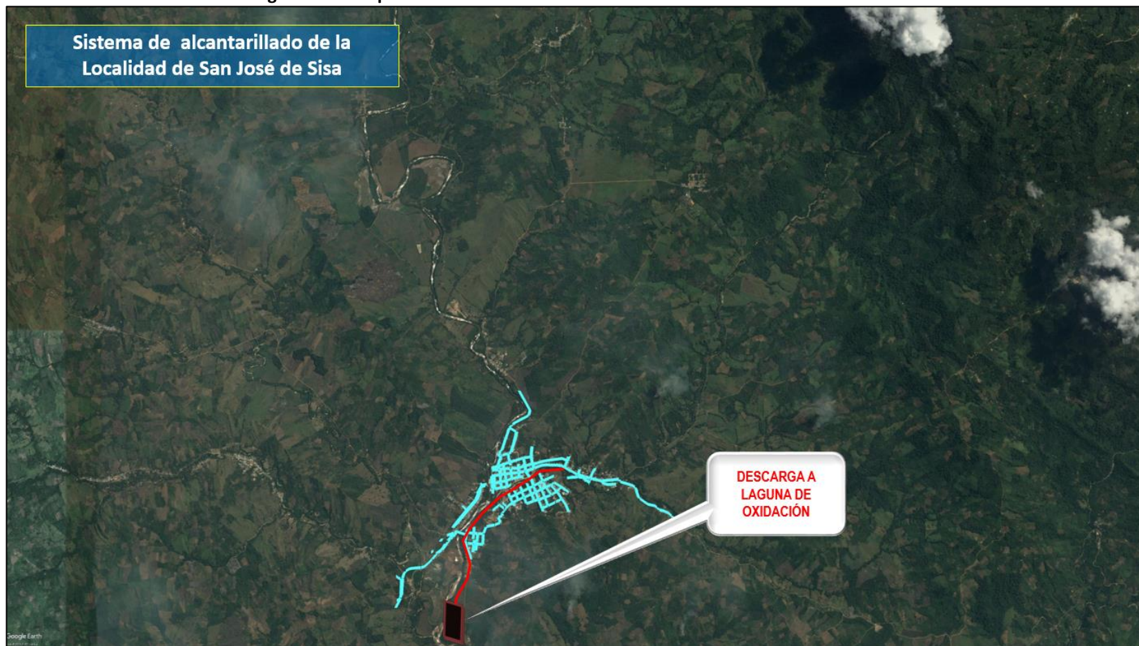
Imagen N° 36: Esquema del sistema de alcantarillado de la localidad de San José de Sisa
