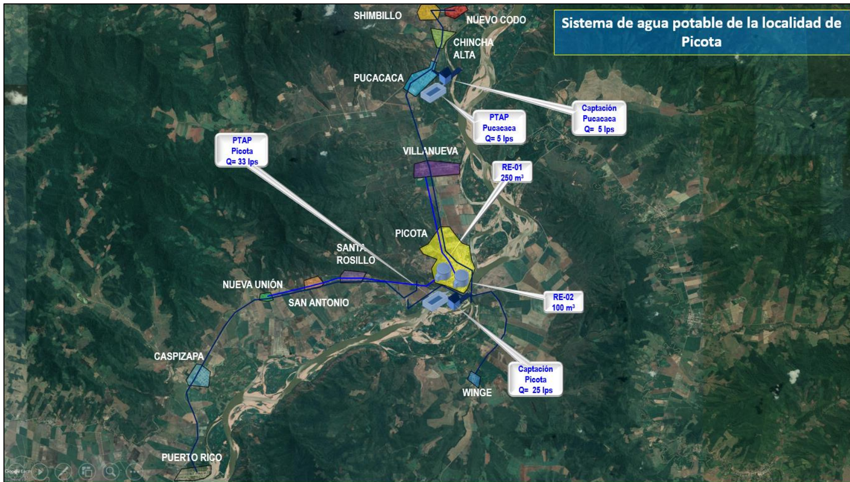
Imagen N° 50: Esquema del sistema de agua potable de la localidad de Picota
