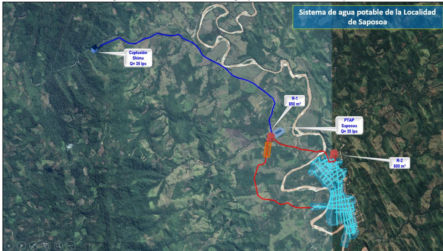
Imagen N° 25: Esquema del sistema de agua potable de la localidad de Saposoa
